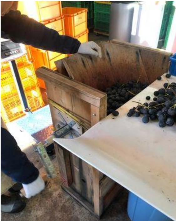
ブドウを搾る機械（イタリア製、手動の油圧）
